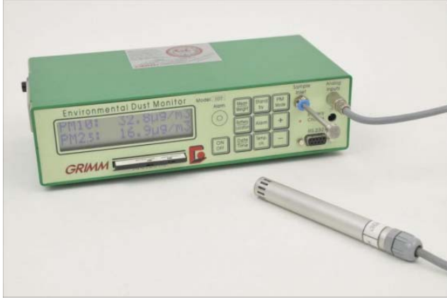
Şekil 2. Partikül madde ölçüm cihazı (Grimm EDM 107)
