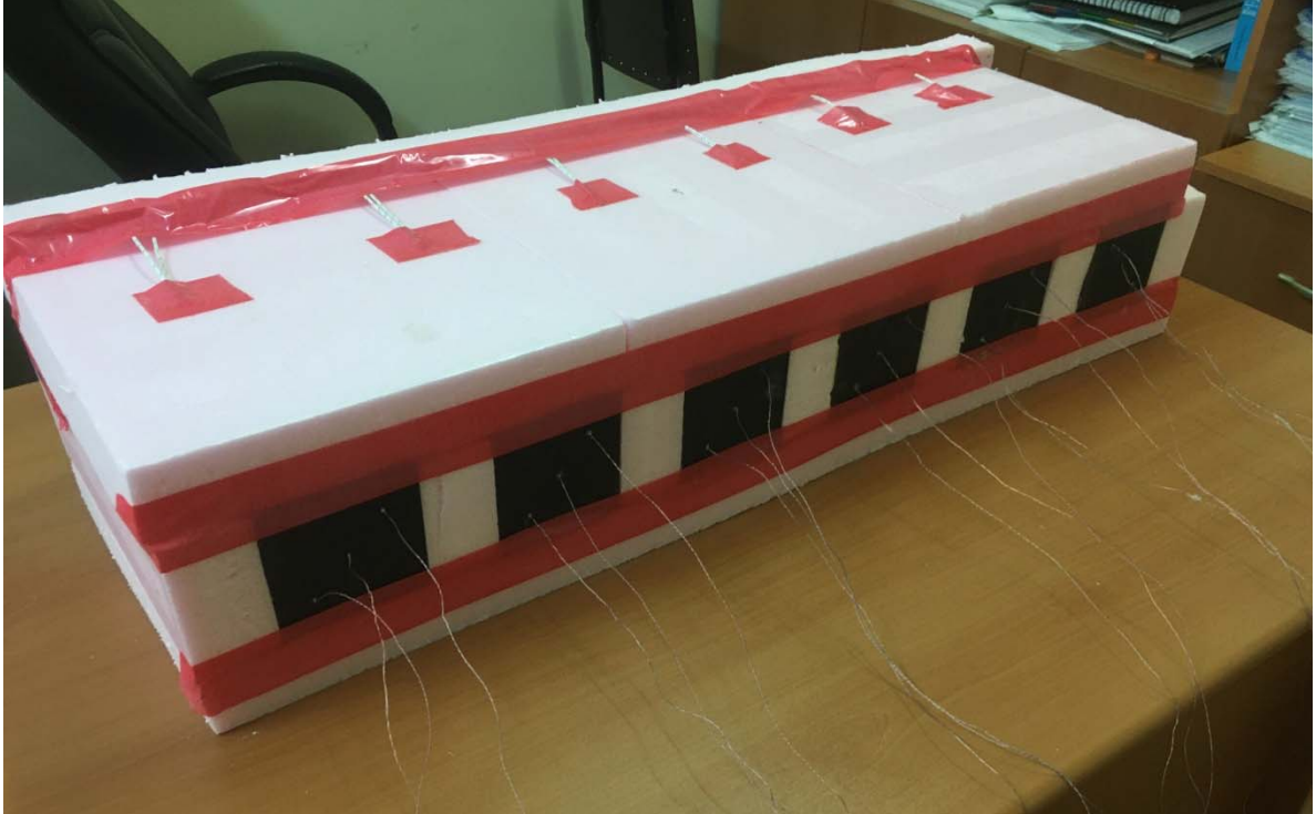
Şekil 3. Bina dış duvar benzetimi.
