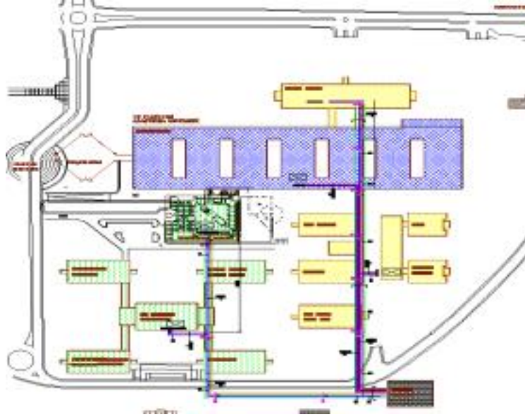
Şekil 1. Yerleşke ısı kanal şeması
