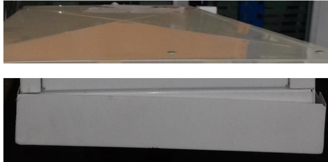
Şekil 8. Eski tarz evaporatörlerde drenaj tavası yapısı
