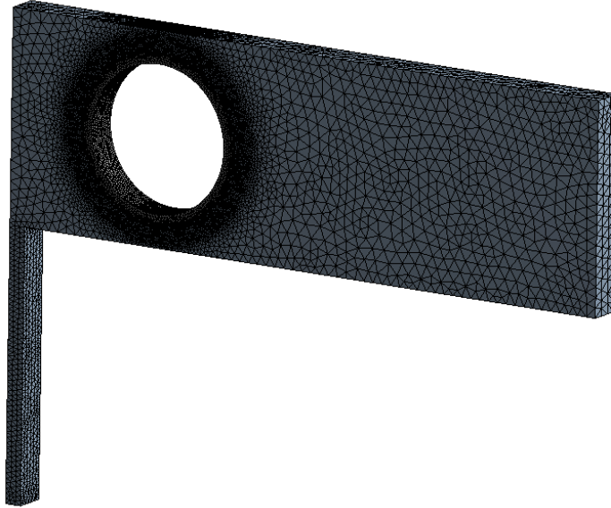
Şekil 5. 642815 eleman sayısına sahip sayısal modelin çözüm aęı yapısı
