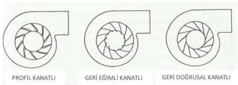
Şekil 4. Yüksek verimlilikteki üç tip santrifüjlü fan prensip tipleri
