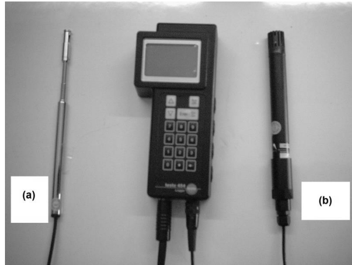
Şekil 1. Testo 454 veri toplama cihazı (a) hava hızı ölçüm probu (b) ortam sıcaklığı ve bağıl nem ölçüm probu
