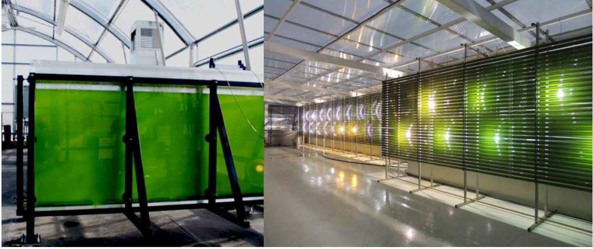
Şekil 3. Gün ışığı ve yapay ışık kullanan fotobiyoreaktörler [13,14]
