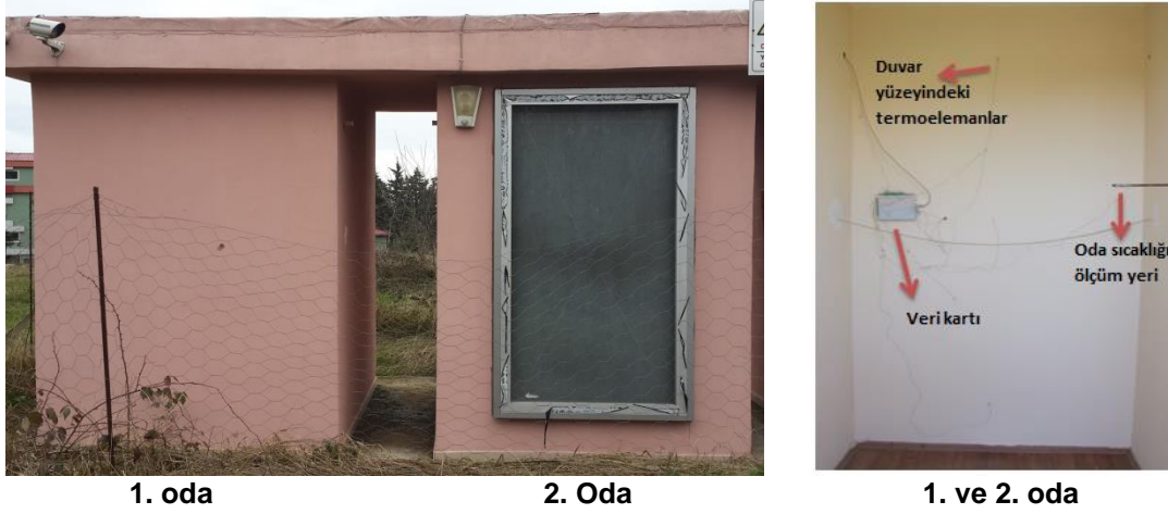
Şekil 3. Deney düzeneğindeki odalar ve odaların içinde yer alan ölçüm elemanları
