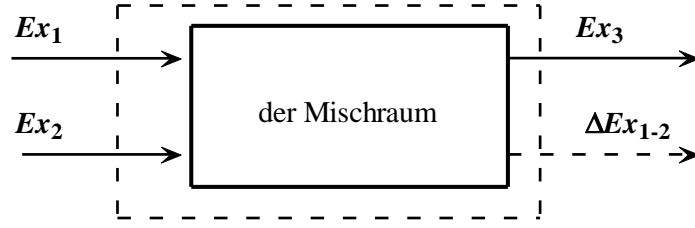
Şekil 2. Karıştırma hacminde ekserji kaybı
