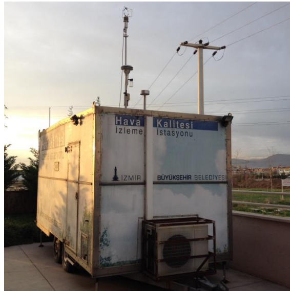
Şekil 4. Dış hava ölçüm sistemi
