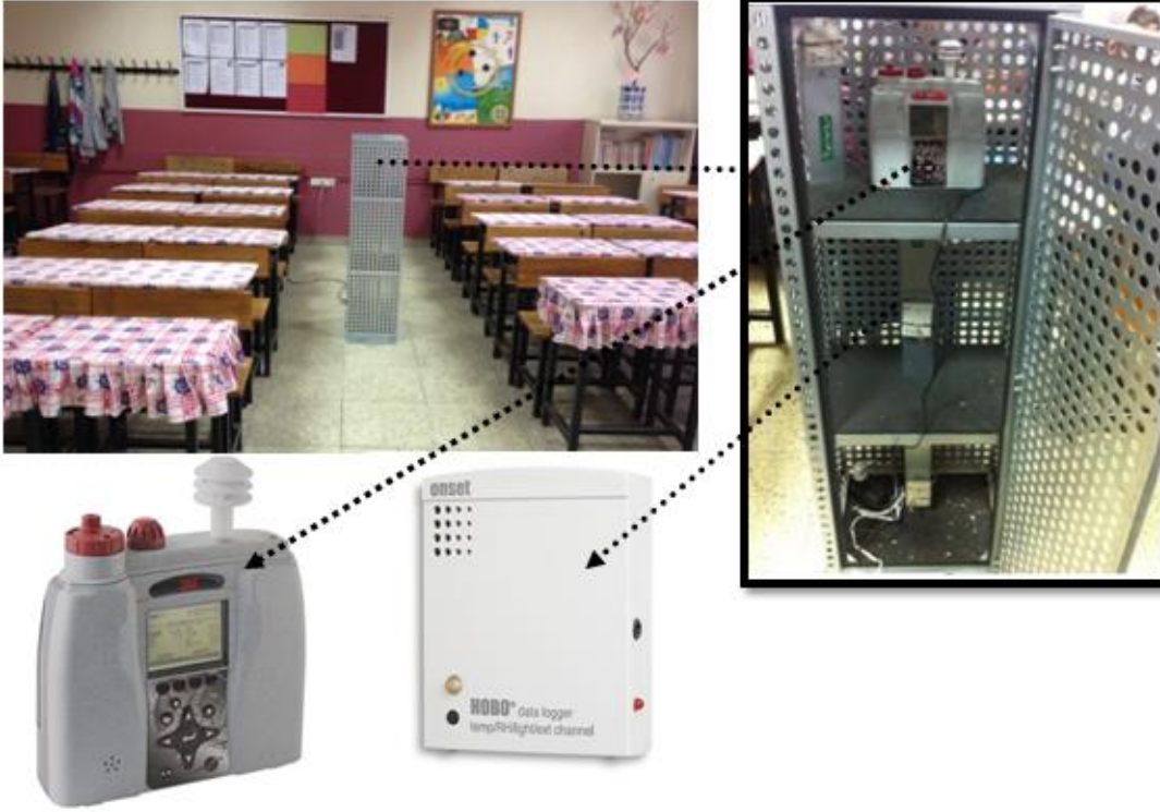
Şekil 3. Sınıf içi ölçüm sistemi
