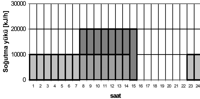
Şekil 4. Mekan soğutması için "kısmi depolama"lı strateji.
