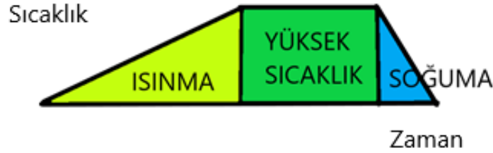
Şekil 5. Süreksiz Çalışan Fırınlarda Sıcaklık-Zaman İlişkisi [2]
