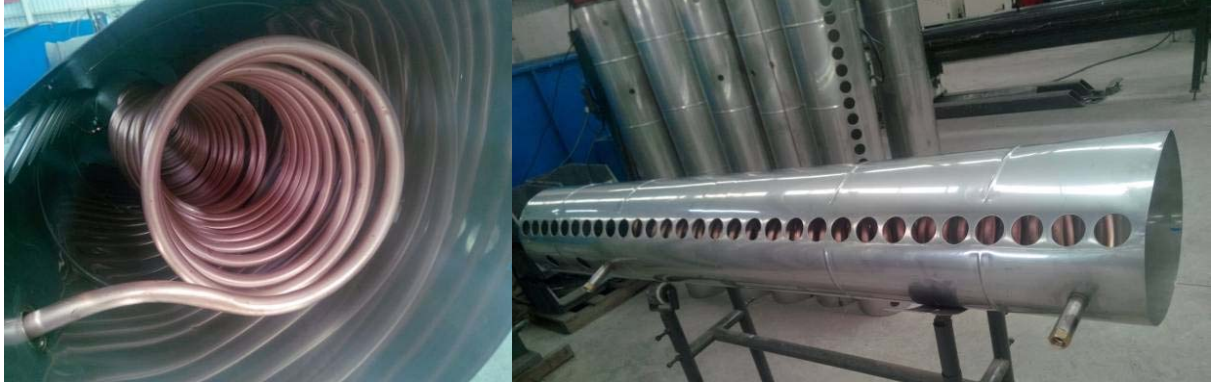
Şekil 3. Isı depolama ünitesinin bileşenleri ve iç görünümü
