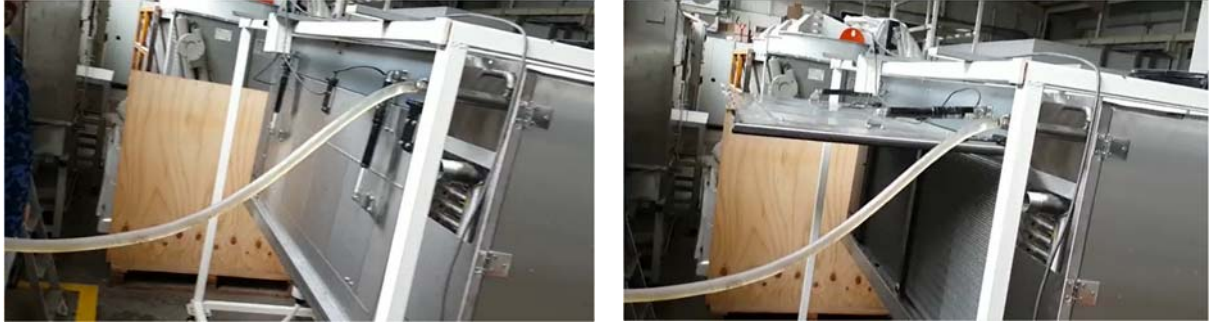
Şekil 1. Defrost Flap'ın Kapalı ve Açık Durumu
