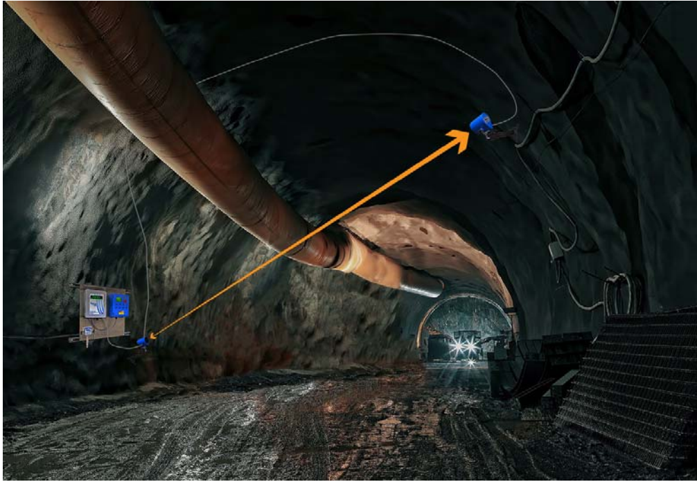
Şekil-14. Madende galeride ultrasonik hava akışı ölçüm sistemi [32]
