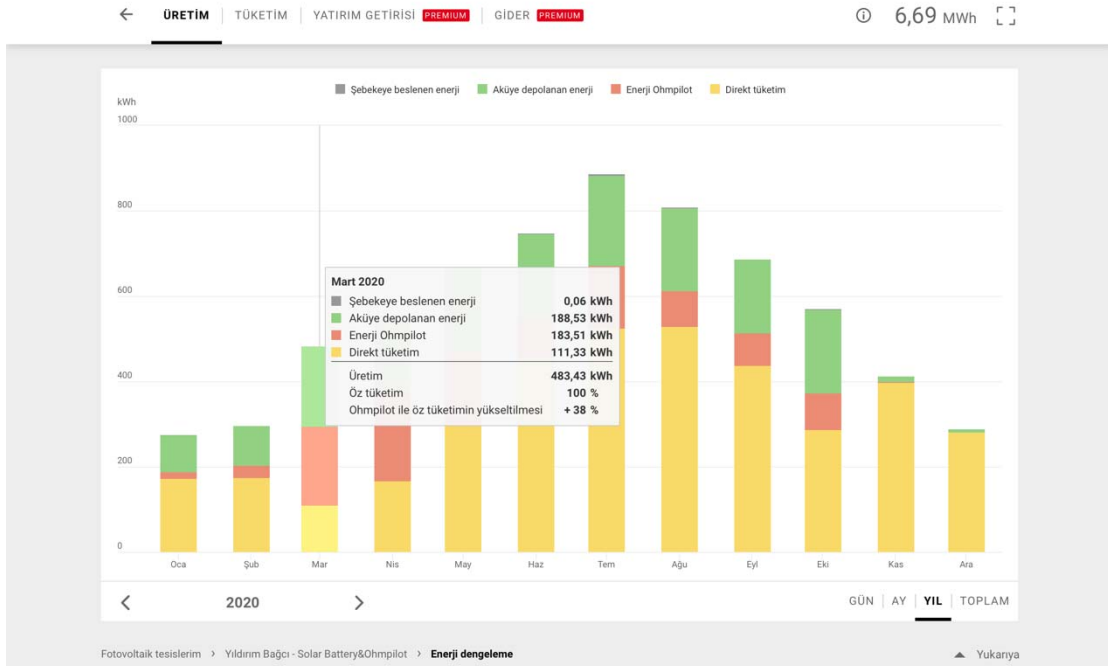
Şekil 7. 2020 yılı için güneşten elde edilen enerjinin dağılımı, Lityum iyon bataryalarda yapılan depolama miktarı ve ısıtma sistemine yapılan katkı
