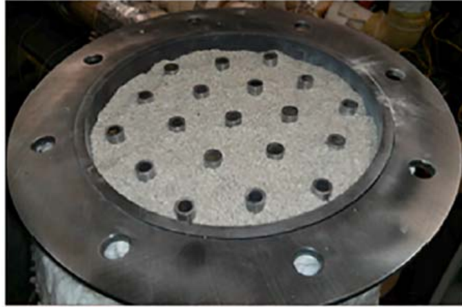
Şekil 7 Borulu eşanjör TED sistemi [30]
