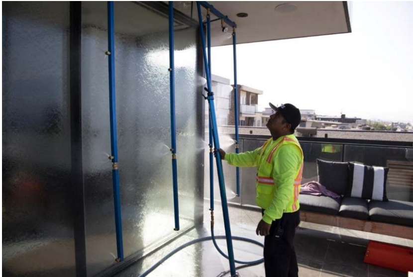
Saha su geçirimsizlik testi (ASTM E 1105)
