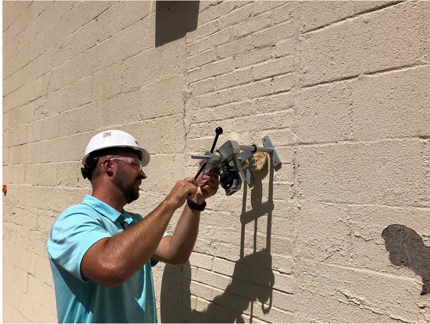
Yapışma/Aderans çekme testi (ASTM D 4541)
