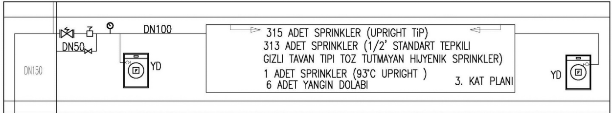
Şekil 13. Yangından Korunma Tesisatı Akış Şeması 3 kat.
