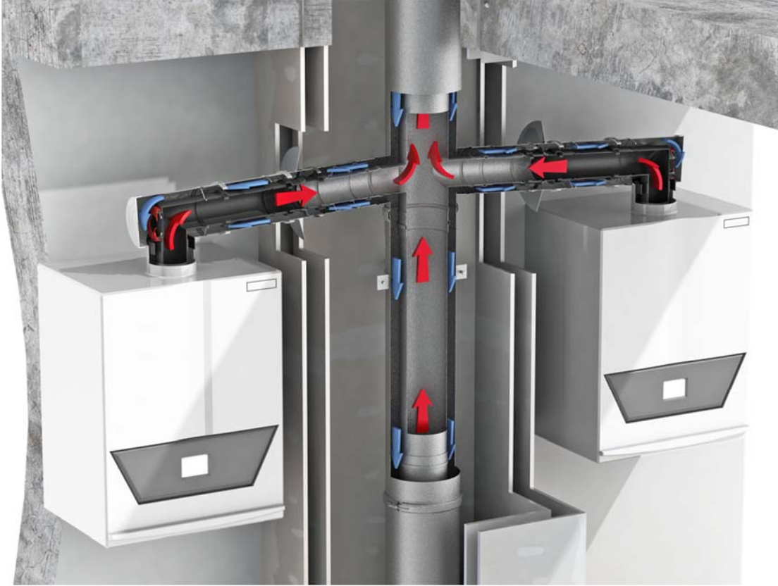
Şekil 34. Hava Atıkgaz Sisteminde Yakıcı Cihaz Bağlantı Detayları
