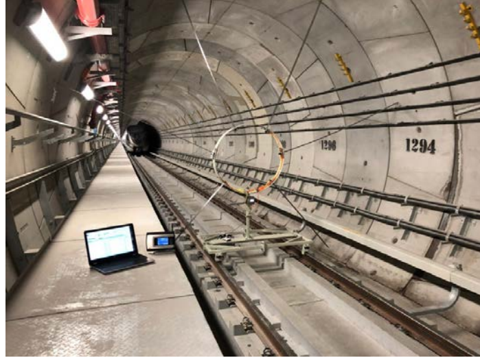
Şekil 3 Hava Hızı Ölçüm Sistemi
