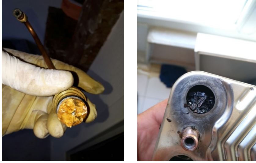
Şekil 8. Kombi Sıcak Su ve Plakalı Eşanjör Kışır Birikintisi (500 h)
