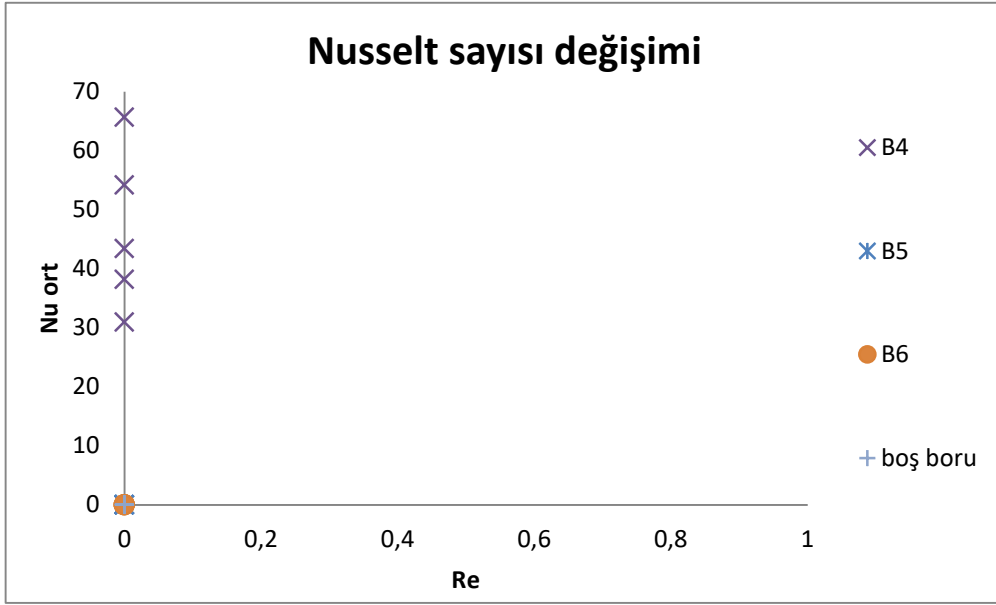
Şekil 7. Boş boru, B4, B5, B6 şerit elemanların Reynolds sayısına göre ortalama Nusselt sayısı değişimi.
