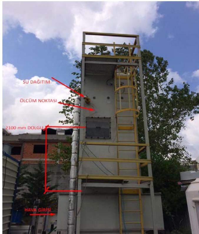
Şekil 3. Soğutma Kulesi Deney Düzeneği
