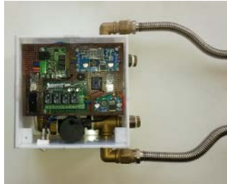
Şekil 33. By-pass pompa ünitesi
