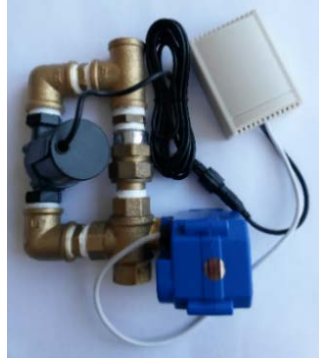
Şekil 30. By-passlı dolaşım pompa ünitesi
