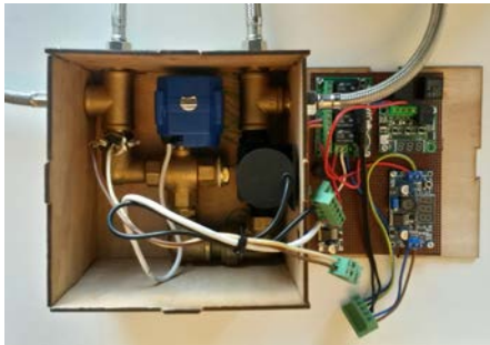
Şekil 35. Musluk altı sirkülasyon ünitesi
