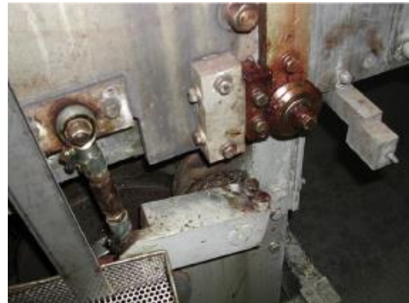
Şekil 6. Uygun olmayan bağlantı elemanı ve kaynak çözümleri [5].
