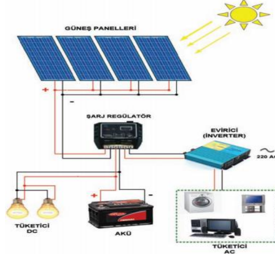
Şekil 7. Fotovoltaik sistemin temel çalışma prensibi [12]
