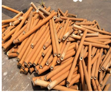
Şekil 4. Tesisten kirlenen kartuş filtrelerinin görünümü.
