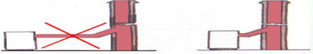
Şekil 44. Baca bağlantı boruları olabildiğince kısa ve yukarıya doğru eğimli olmalıdır.
