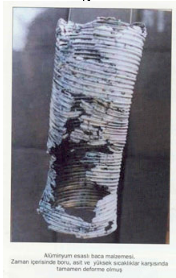
Şekil 53. Bacalı cihazların bağlantılarında alüminyum fleks bağlantılardan kaçınılmalı yerine çelik malzemeler tercih edilmelidir.
