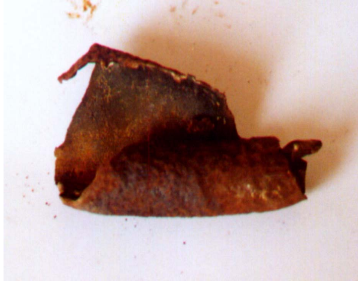
Resim 3. Homojen dağılımlı korozyona uğramış boru parçası
