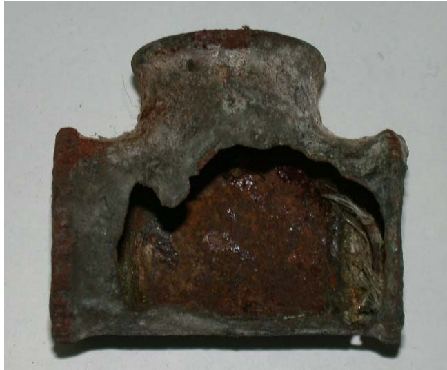
Resim 10. Diğer bir dirsekte oluşan delik
