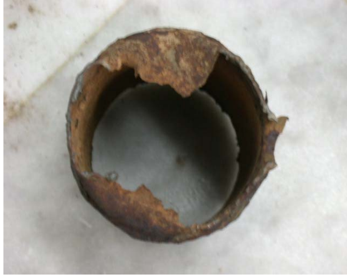
Resim 4. İncelerek kopan boru parçası
