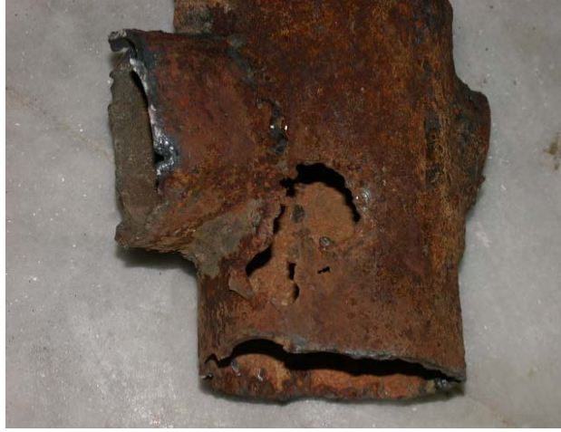
Resim 9. Dirsekte oluşan delik
