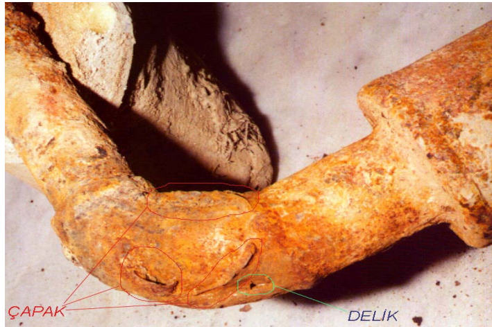
Resim 14. Dirsek yüzeyinde görülen ezilme, çapak ve delik
