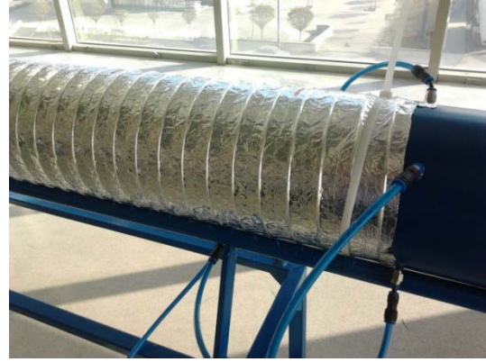
Şekil 4. (a) 15° Bükülme Açılı Tam Gerdirilmiş Esnek Kanal ve (b) Basınç Ölçüm Bağlantıları
