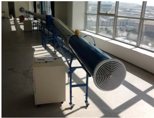
Şekil 2. (a) 15° Bükülme Açılı (b) 60° Bükülme Açılı Tam Gerdirilmiş Esnek Kanal Deney Düzeneği
