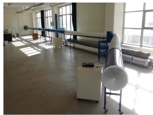
Şekil 2. (a) 15° Bükülme Açılı (b) 60° Bükülme Açılı Tam Gerdirilmiş Esnek Kanal Deney Düzeneği
